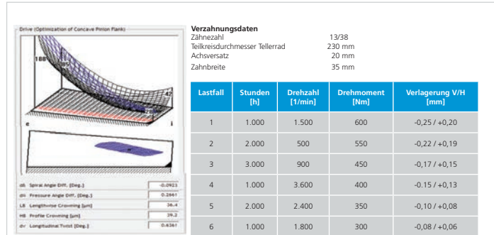
Abb. 14: Optimierte Ease-Off-Gestaltung und Lastkollektiv
